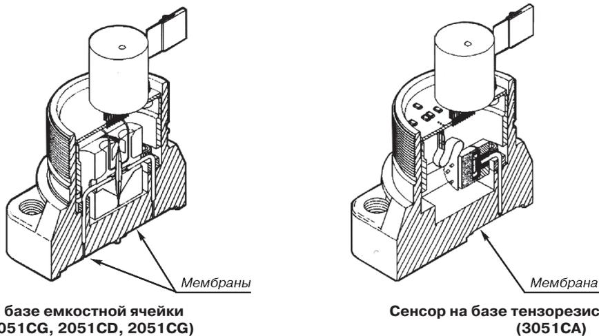
Сенсор на базе емкостной ячейки
