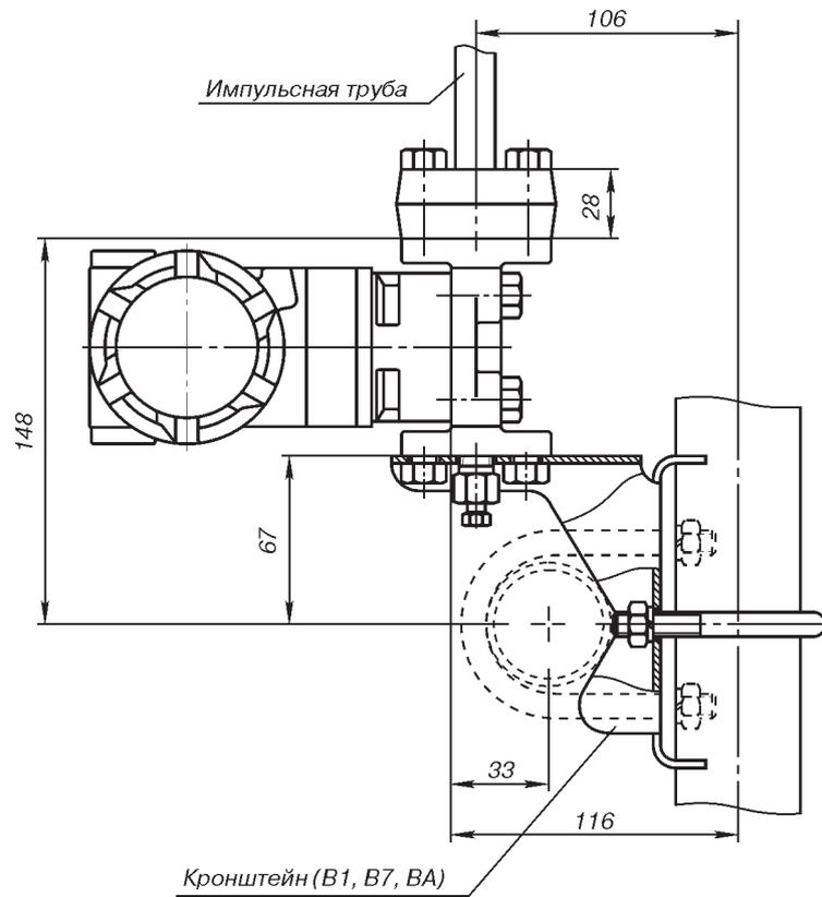
Пунктирной линией показан вариант крепления датчика на горизонтальной трубе.
