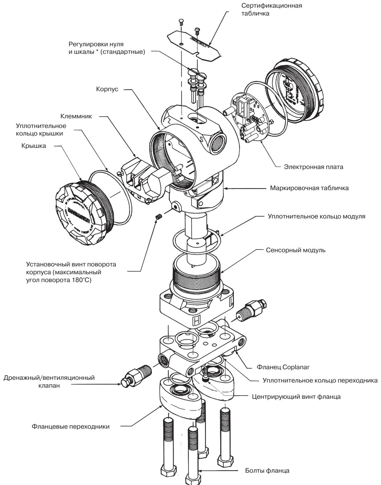
**Рис. 6. Типовой преобразователь давления 3051C в разобранном виде.**
