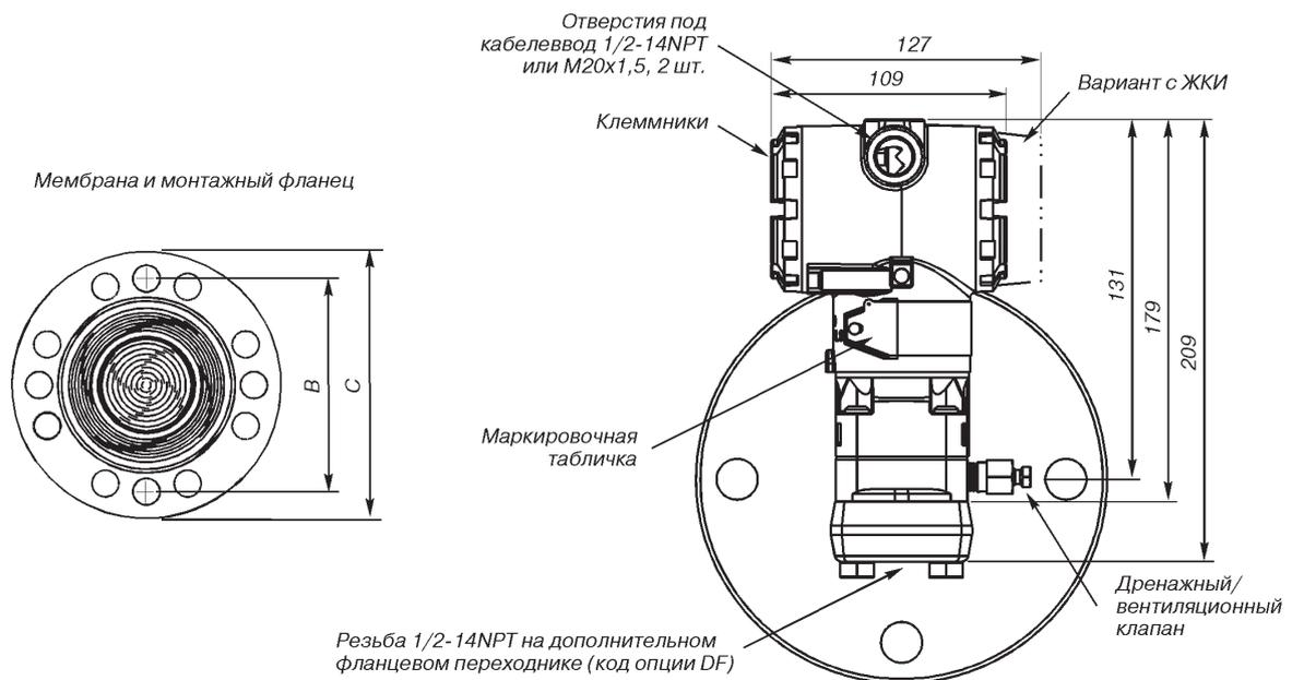
Рис. 14. Датчик давления 3051\_L для измерения уровня.
