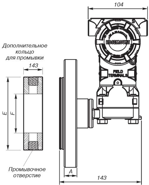
Рис. 12. Конфигурация датчика 3051\_L с фланцем заподлицо.
