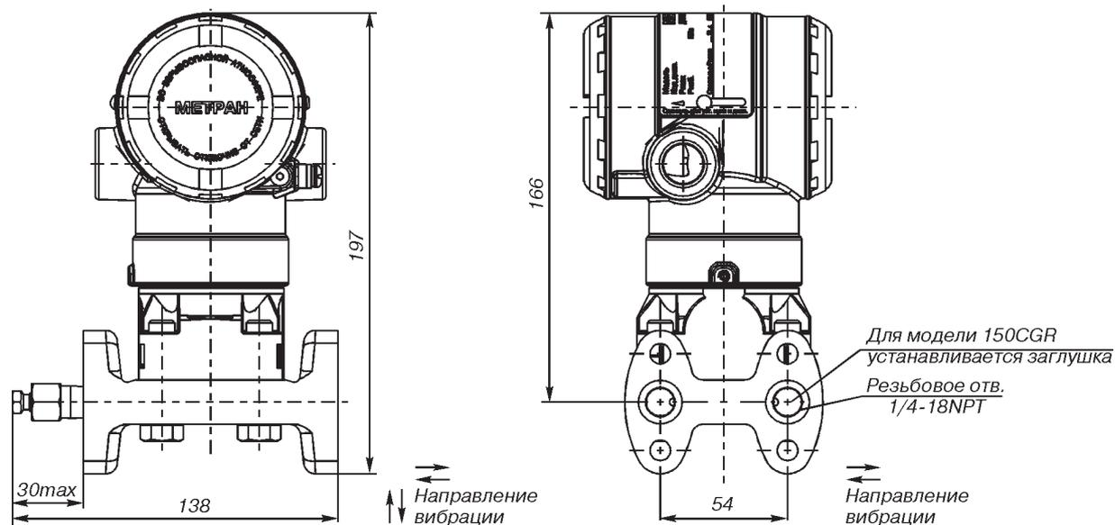
Рис.26. Датчики мод. 150CDR и 150CGR с традиционным фланцем.
