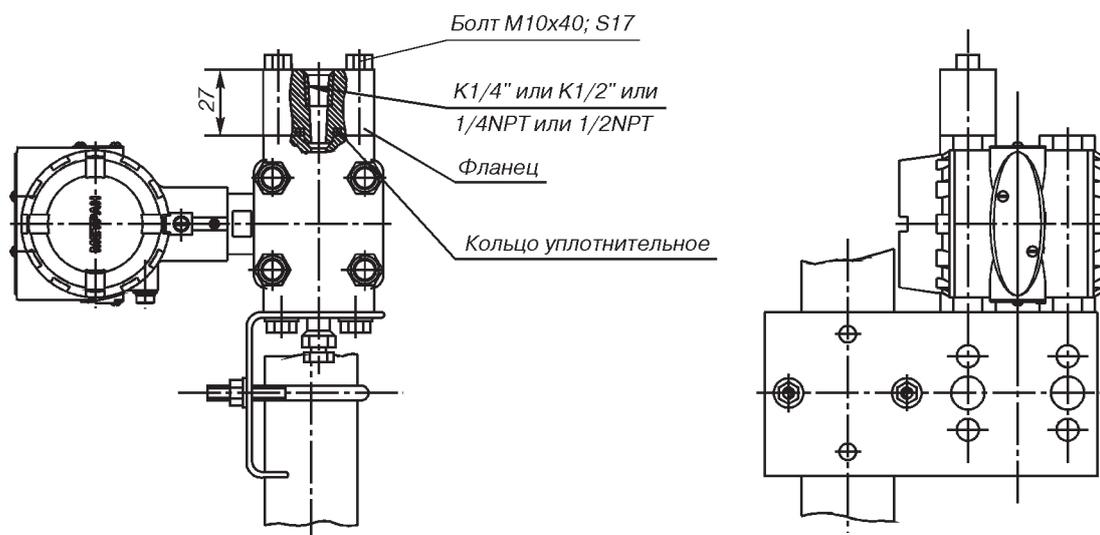
Рис. 17. Датчики мод. 150CG с установленным монтажным фланцем с резьбовым отверстием K1/4" (код D1), или K1/2" (код D2), или 1/4NPT (код D3), или 1/2NPT (код D4) и монтажным кронштейном для установки на трубе  $\phi 50$  мм (код B1).
