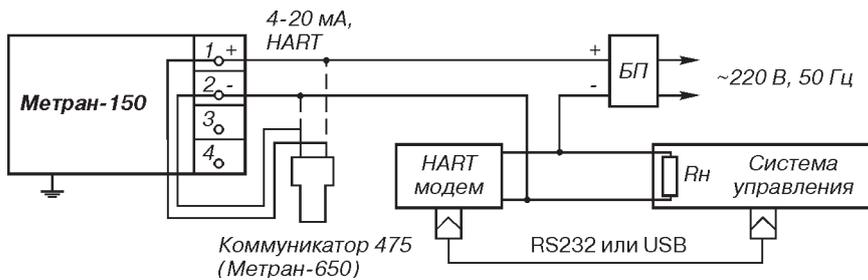
Рис.9. Вариант включения датчика с HART-модемом или HART-коммуникатором.
