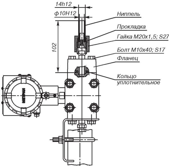
**Рис. 19.** Датчики мод. 150CD с установленными ниппелями под накидные гайки M20x1,5 (код D5) и монтажным кронштейном для установки на трубе ф50 мм (код В1).
