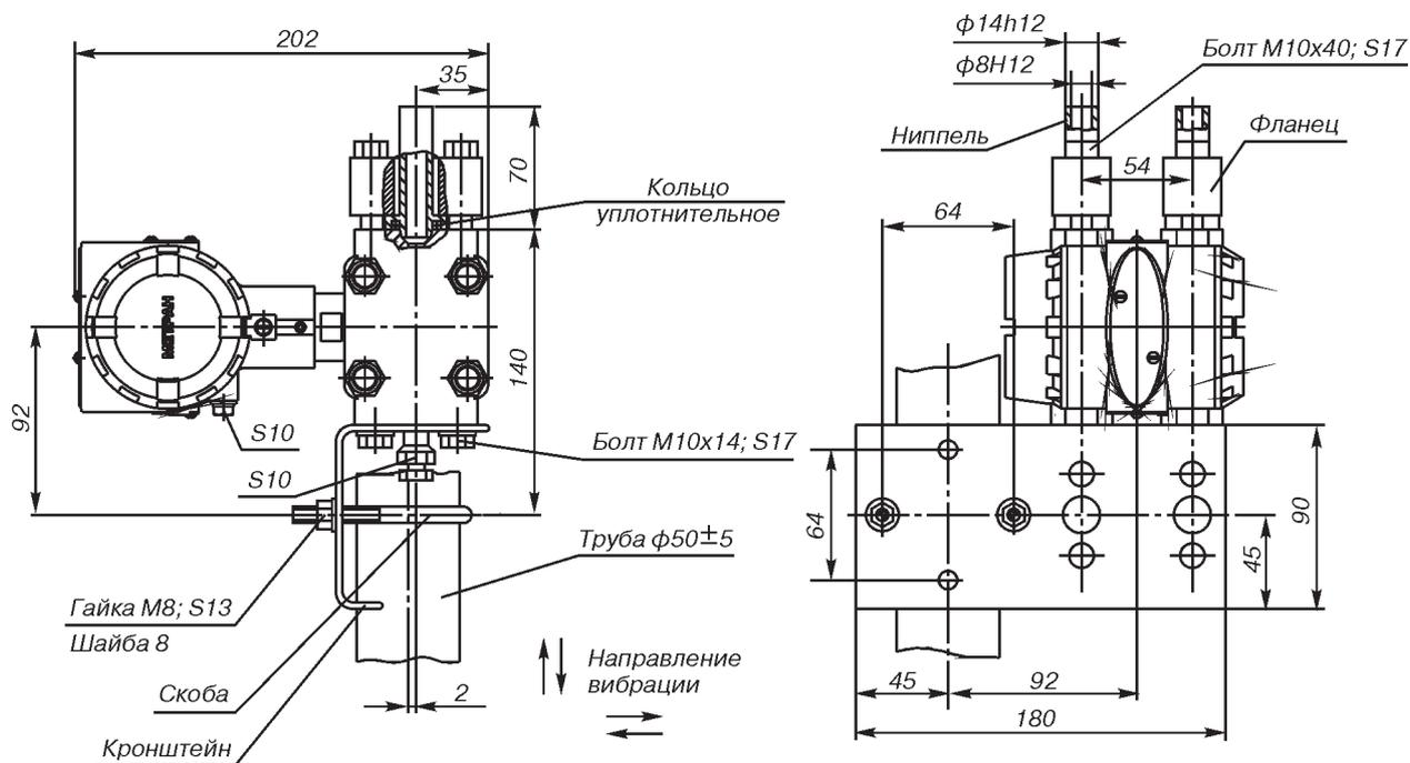
Рис. 18. Датчики мод. 150CD с установленными ниппелями (код D6) и монтажным кронштейном для установки на трубе  $\phi 50$  мм (код B1).
