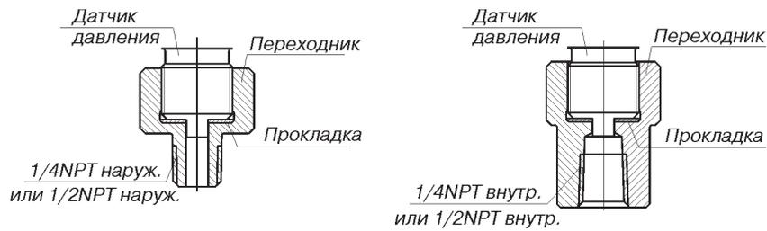
**Рис.24. Датчики мод. 150TG, TA. Установка монтажных деталей - переходников типа 1/4NPT наружная (код 2D) или 1/2NPT наружная (код 2E) или типа 1/4NPT внутренняя (код 2A) или 1/2NPT внутренняя (код 2B). Остальное см.рис.23.**
