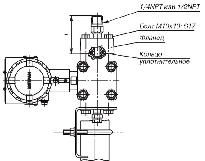
Рис. 16. Датчики мод. 150CG с установленным монтажным фланцем со штуцером 1/4NPT (код D7) или 1/2NPT (код D8) и монтажным кронштейном для установки на трубе ф50 мм (код B1).
