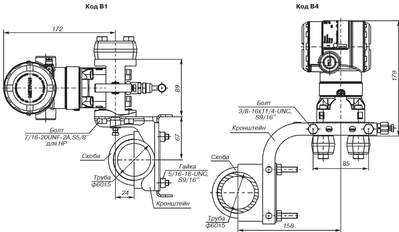
Рис.27. Датчики мод. 150CDR и 150CGR с традиционным фланцем и монтажным кронштейном.
