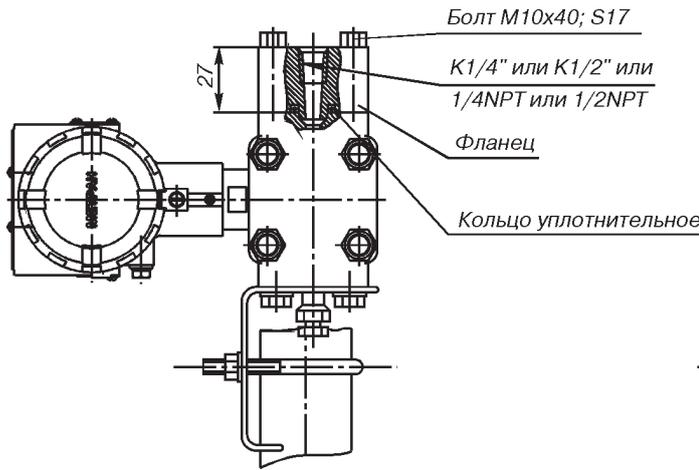
**Рис. 21.** Датчики мод. 150CD с установленными монтажными фланцами с резьбовым отверстием K1/4" (код D1), или K1/2" (код D2), или 1/4NPT (код D3), или 1/2NPT (код D4) и монтажным кронштейном для установки на трубе ф50 мм (код В1).
