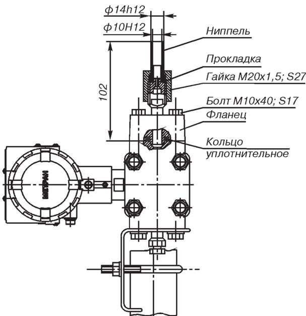
Рис. 15. Датчики мод. 150CG с установленным ниппелем под накидную гайку M20x1,5 (код D5) и монтажным кронштейном для установки на трубе ф50 мм (код B1).
