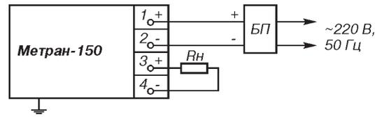
Рис.7. Выходной сигнал 0-5 мА (4-х-проводная линия связи).
