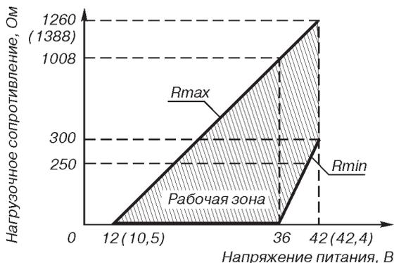
Для работы по HART-протоколу  $R_{min}=250$  Ом
