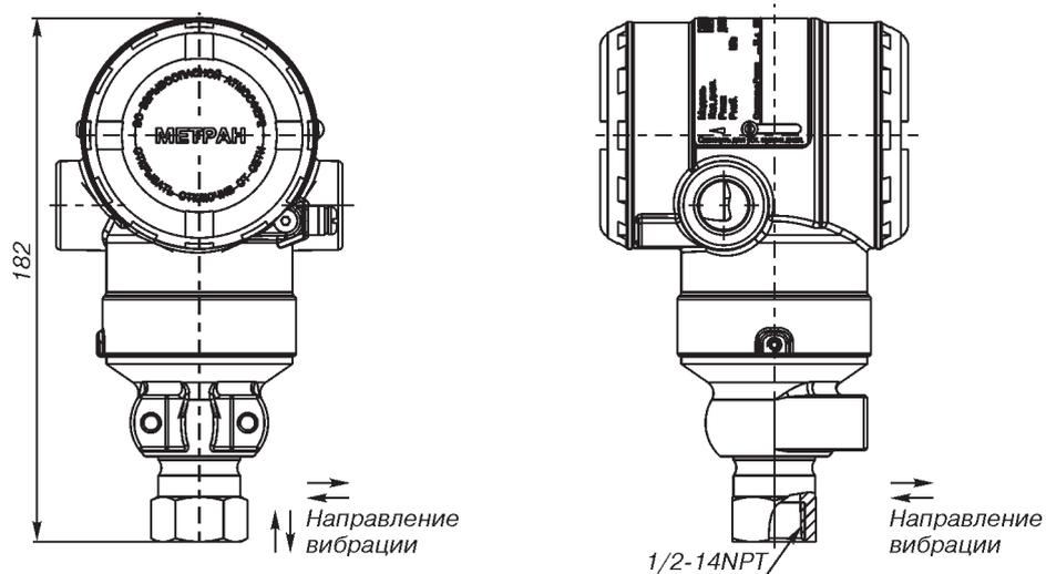
Рис.30. Датчики мод. 150TGR и 150TAR с кодом технологического соединения 2В.
