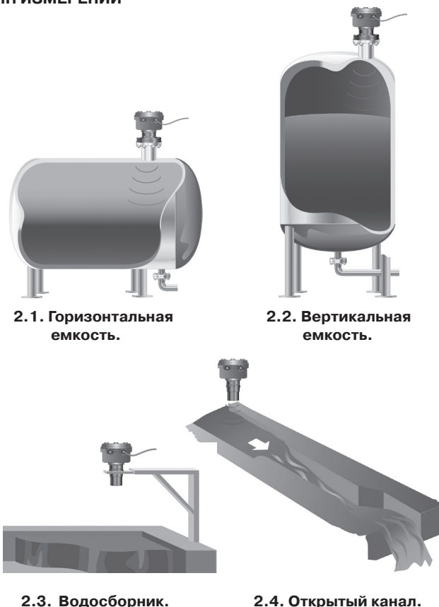
Рис. 2. Примеры установки уровнемеров 3100.
