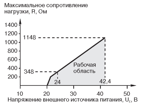
Рис. 17. Диаграмма сопротивлений для уровнемера, сертифицированного на взрывобезопасность.
