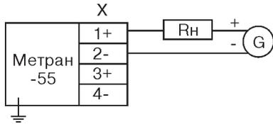
Вариант подключения нагрузки для датчика с выходным сигналом 4-20 мА
