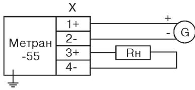
Для датчиков с выходным сигналом 4-20 мА
